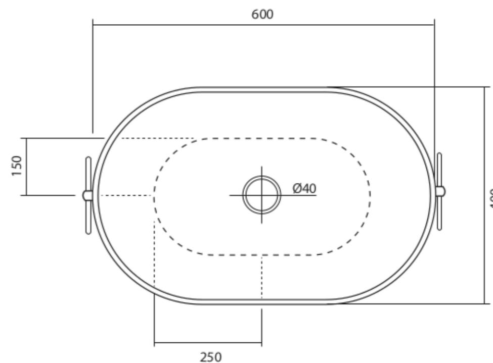
N.B. Le misure indicate possono subire una variazione del 2% circa, dovuta ad usura stampi e a variazioni delle caratteristiche tecniche relative alle materie prime che compongono l'impasto
